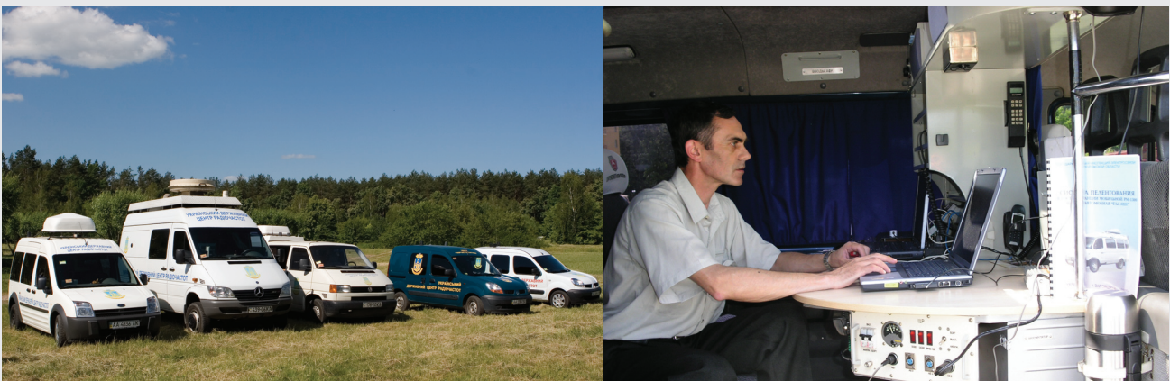
Мобільні комплекси радіочастотного моніторингу. Зовнішній вигляд та встановлене обладнання
